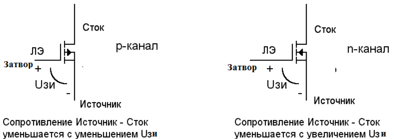
Рис. 1.15. Условные обозначения МОП транзисторов с каналами р и п типов ( U_{зи} -напряжение между Затвором и Источником).
