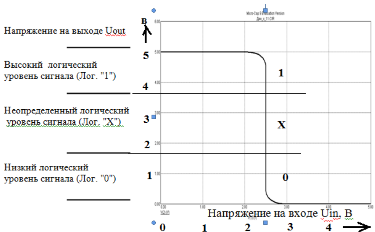
Рис. 1.19. Характеристика вход – выход КМОП инвертора.
