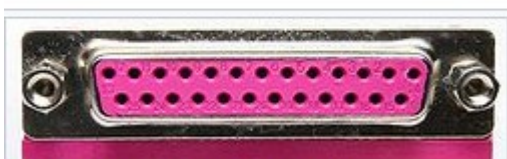
25-контактный разъем DB-25, используемый как LPT-порт на персональных компьютерах (IEEE 1284-A)
