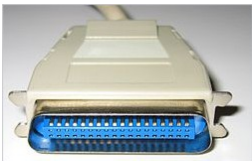
Кабельный 36-контактный разъем Centronics для подключения внешнего устройства (IEEE 1284-B)
